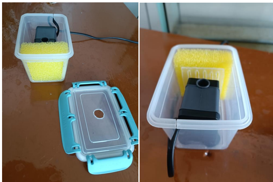
Рисунок 4 – Защитное устройство с установленной губкой
