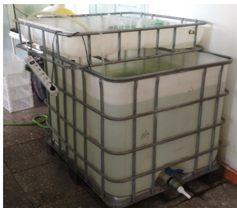
Рисунок 1 - Установка замкнутого водоснабжения (УЗВ) с системой биофильтрации изготовленная из Еврокуба
